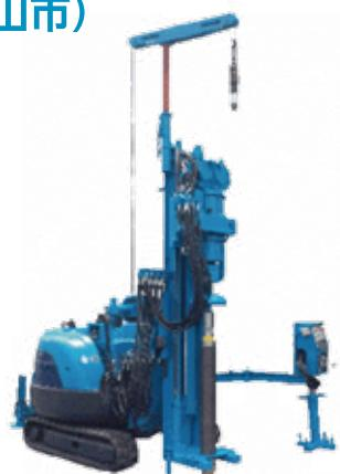
本事業では小規模施設において地中熱利用システムを導入するにあたり、日本大学工学部機械工学科【再生可能エネルギーシステム研究室】との共同開発によって、既存のボーリングマシンに改良・開発を施し、全国初の一般住宅専用地中熱ボーリングマシンの開発に成功した。
